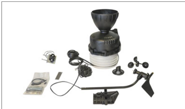
**Include:** Pluviometro, Anemometro, Sensore radiazione solare, Sensore temperatura e umidità aria.
