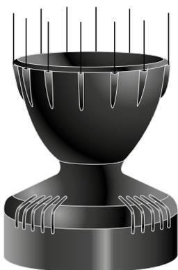
**1.** Rimuovere la pale eoliche per anemometro imballate nella parte superiore del pluviometro.
