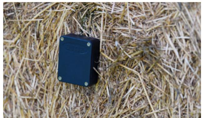
**InFarm** è dotato di un'unità di controllo completamente indipendente (non è necessaria alcuna linea di alimentazione) in grado di leggere tutti i dati provenienti dai sensori cablati e inviarli al cloud tramite un modem GSM integrato.
